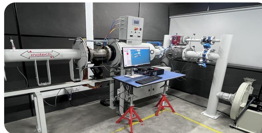
Calibración de medidores rotativo – Turbina alcance de medición desde 0,65 \text{ m}^3/\text{h} a 1000 \text{ m}^3/\text{h}
