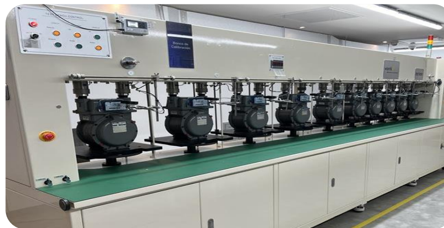
Calibración de medidores gas tipo diafragma alcance de medición desde 0,016 \text{ m}^3/\text{h} a 40 \text{ m}^3/\text{h}
