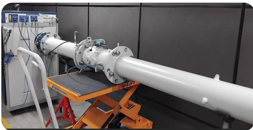
Calibración de medidores rotativo – Turbina alcance de medición desde 0,65 \text{ m}^3/\text{h} a 1000 \text{ m}^3/\text{h}
