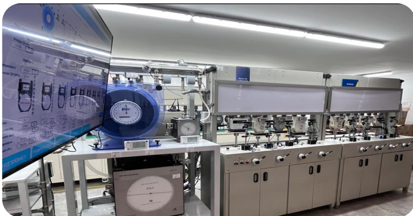
Calibración de medidores gas tipo diafragma alcance de medición desde 0,016 \text{ m}^3/\text{h} a 40 \text{ m}^3/\text{h}
